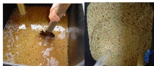
H29: Cho nước đủ ngập, trộn kỹ enzym với cà phê, ủ 2 hoặc 10 tiếng rồi rửa sạch
